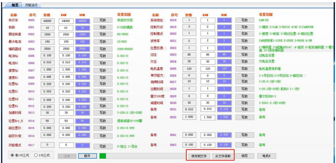
(8) 电机 B 参数修改：点击“连接”后，点击右下角“电机 B”，进入电机 B 界面，等待进度条刷新出数据：
