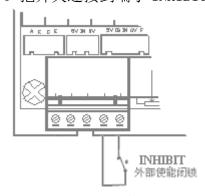
当"使能控制端"两端闭合时,控制器内部电路会迅速提升马达转速,直到 MAX SPD 设定值上。
